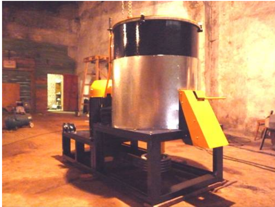
Світлина 1. Малогабаритний пристрій для виробництва сухих комбінованих енергопротеїнових кормових добавок з нехарчових відходів переробки рибної і тваринної сировини
